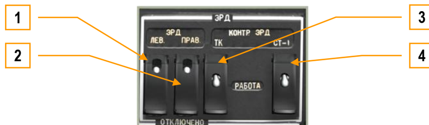
6-60 : Régulateurs électroniques des moteurs (EEG)
