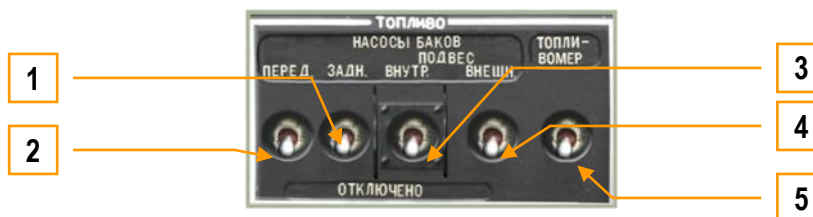
6-54 : Contrôles des pompes carburant
