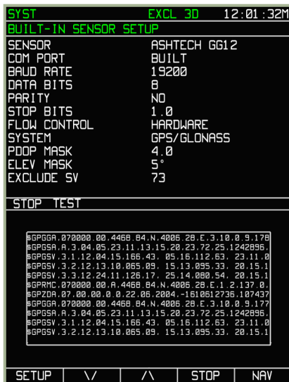
7-102 : Page SYST pendant le test du récepteur GNSS et son canal de communication
