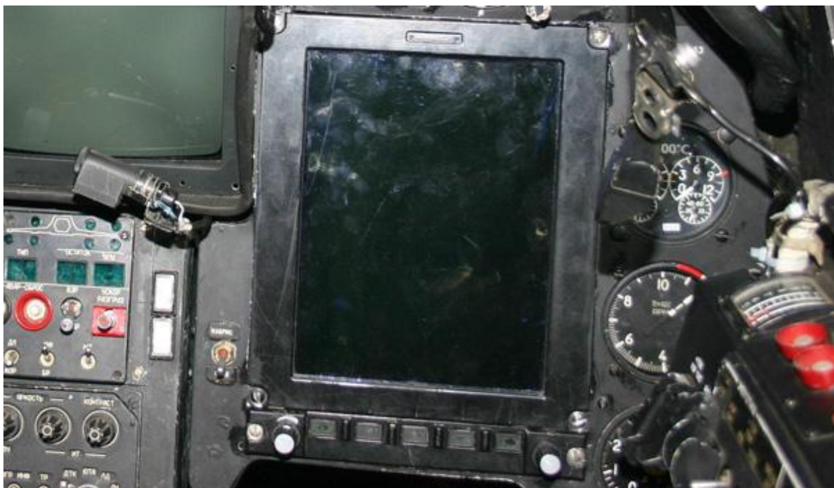
2-8 : Système avancé de carte mobile "ABRIS"
