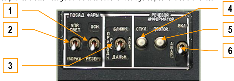
6-41 : Panneau de contrôle des phares d'atterrissage et des alertes vocales ("Betty")
