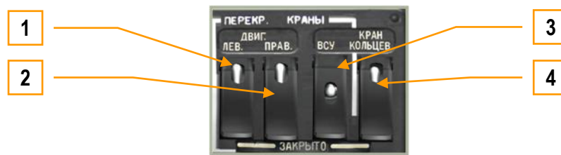
6-56 : Contrôles des vannes coupe-feu
