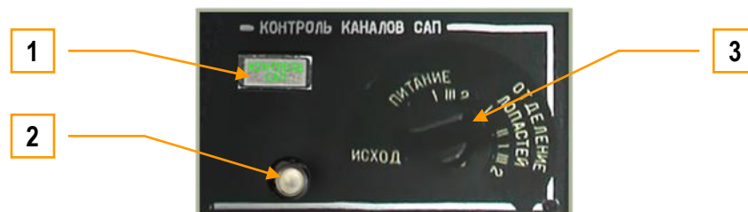
6-65 : Panneau de tests intégrés du système d'éjection automatique
