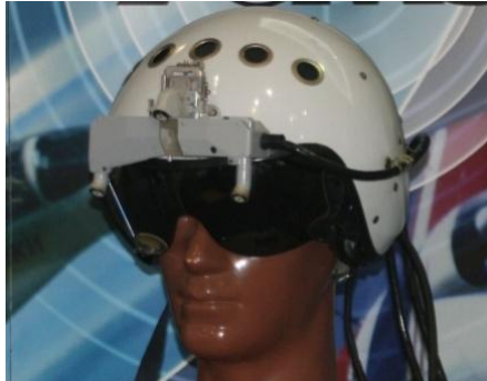
14-8 : Casque avec système de visée intégré (Helmet Mounted Sight "HMS")
