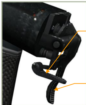
6-5 : Gâchettes des Munitions (grande) et des Canons (petite) en position par défaut – La Gâchette des Munitions est opérationnelle
