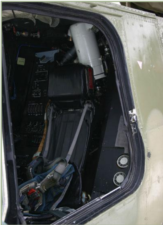
1-8 : Siège éjectable K-37-800 dans le cockpit du Ka-50
