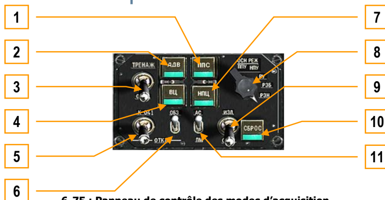
6-75 : Panneau de contrôle des modes d'acquisition
