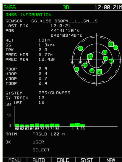
7-99 : Détermination du seuil RAIM par l'utilisateur
