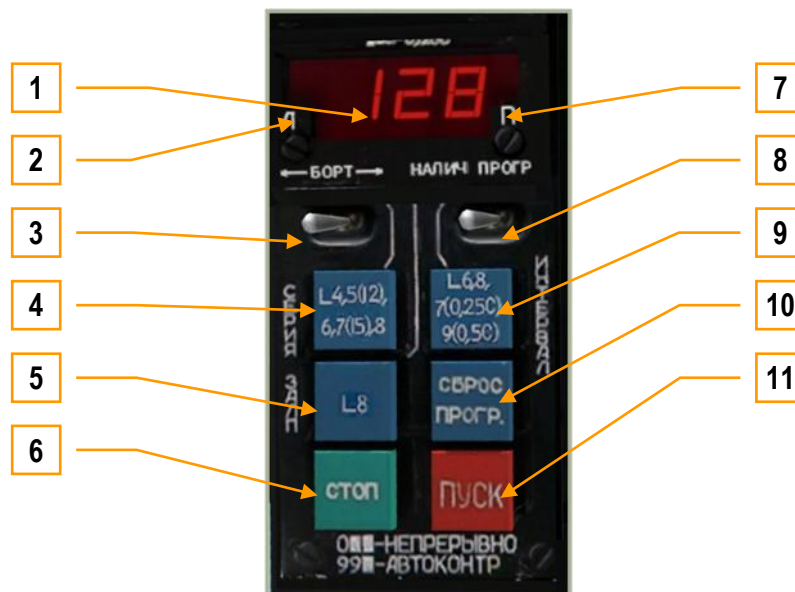
6-34 : Panneau de commande des contre-mesures UV-26
