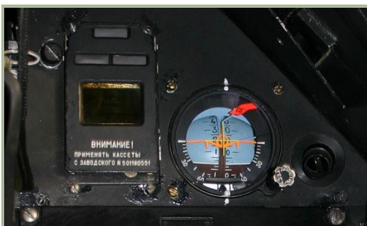
2-5 : Système intégré d'alerte et de contrôle Ekran (gauche) et horizon artificiel de secours (droite) dans le cockpit du Ka-50
