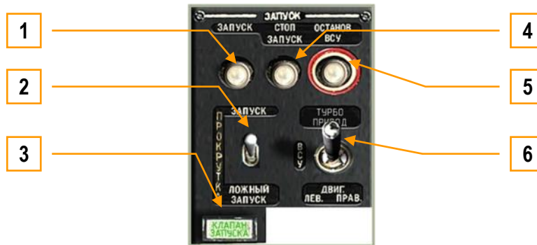
6-76 : Commandes de mise en route des moteurs
