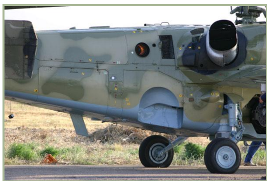
2-3 : Tuyère du groupe auxiliaire de puissance en fonctionnement, et bouche de sortie des turbines principales
