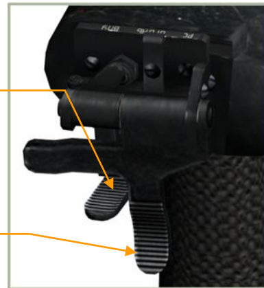
6-6 : Gâchettes des Munitions (grande) et des Canons (petite) en position par défaut – La Gâchette des Munitions est opérationnelle
