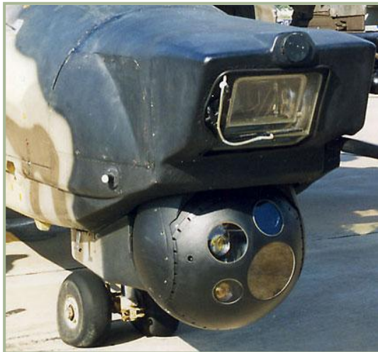
1-13 : Nez du Ka-50Sh avec le système Shkval en haut et le système optoélectronique Samsheet-50 en bas
