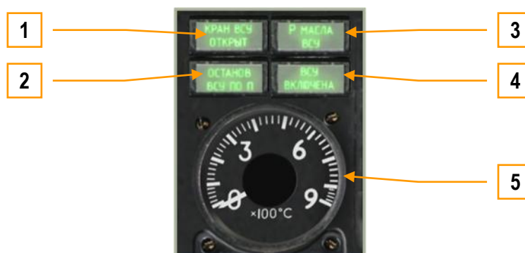
6-78 : Panneau de l'unité auxiliaire de puissance (APU)
