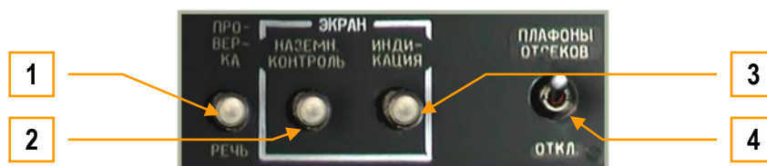
6-67 : Contrôles du système d'alertes EKRAN et du système de messagerie vocale ALMAZ (Betty)
