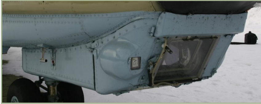
1-7 : Système de désignation TV automatique "Shkval" I-251V
