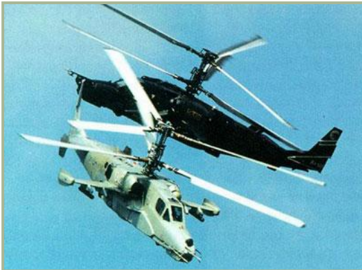
1-9 : V-80 (immatriculé 012) équipé du système de désignation TV à amplification de lumière Mercury (premier plan)
