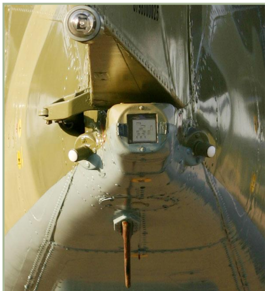
2-7 : Vue arrière du Ka-50. Le feu de navigation blanc est visible en haut. Le capteur laser L0140 est au milieu, et différentes antennes IFF sont situées sur les côtés et en dessous du cône de queue.
