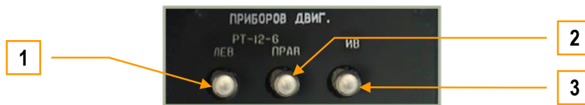
6-64 : Panneau des instruments de contrôles moteurs
