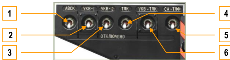
6-53 : Contrôles d'alimentation radio et data link
