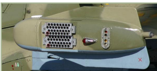
2-9 : Lance leurre UV-26, feu de navigation gauche (rouge), et lanceur de signaux lumineux
