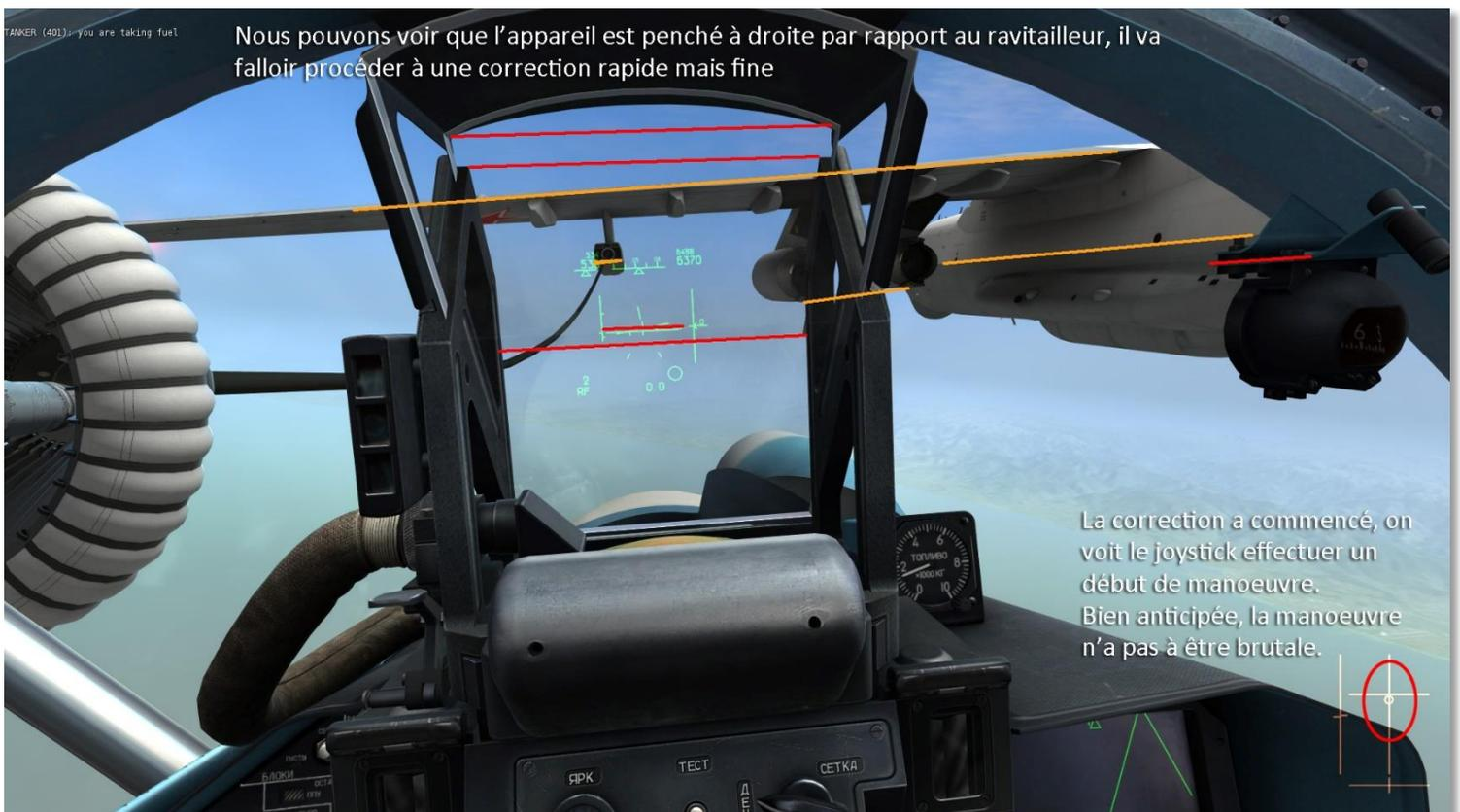
**Exemples d'axes relativement parallèles au niveau du cockpit et du ravitailleur.**
