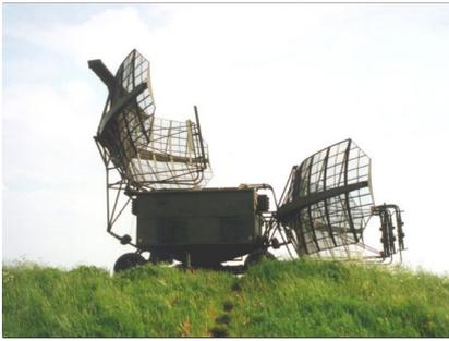
Il se compose de deux aériens primaires (antennes extérieures) qui assurent la détection sur 5 plages de fréquence dans la gamme des 2.6Ghz à 3.3Ghz. Ce radar peut ainsi détecter de multiples types de cibles. Il est également utilisé par le GCI, en combinaison avec les deux autres radars ci-dessous. (le modèle en photo est un modèle est-allemand de 1997 équipé d'un radar secondaire)
