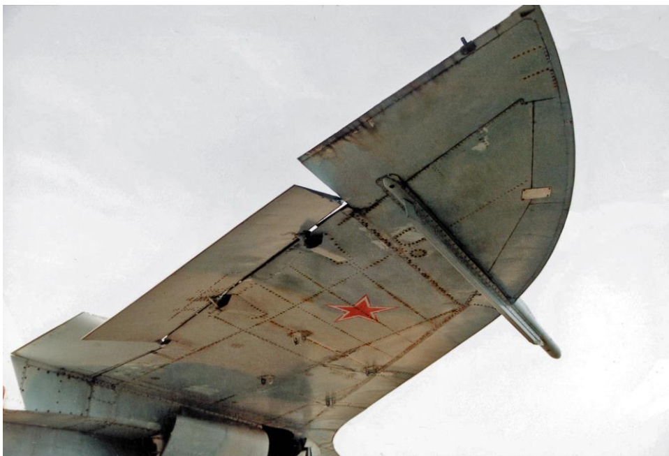
Figure 3 : Voilure du T-10-1
