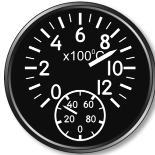
Image 36 : Indicateurs de température des turbines
