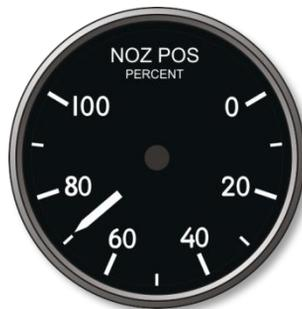
Figure 34. Indicateur de position des tuyères
