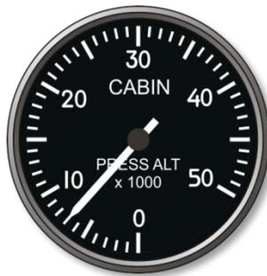
Figure 36. Altimètre de pression cabine
