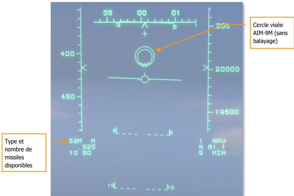
Figure 43. Mode "dans l'axe" du AIM-9M
