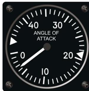
Figure 25. Indicateur d'incidence (AoA)
