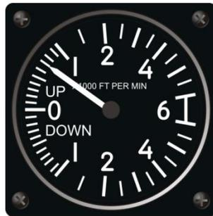
Figure 30. Variomètre (VVI)
