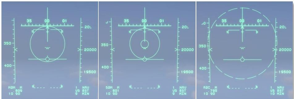
Figure 52. Mode balayage vertical des AIM-7, AIM-9 et AIM-120
