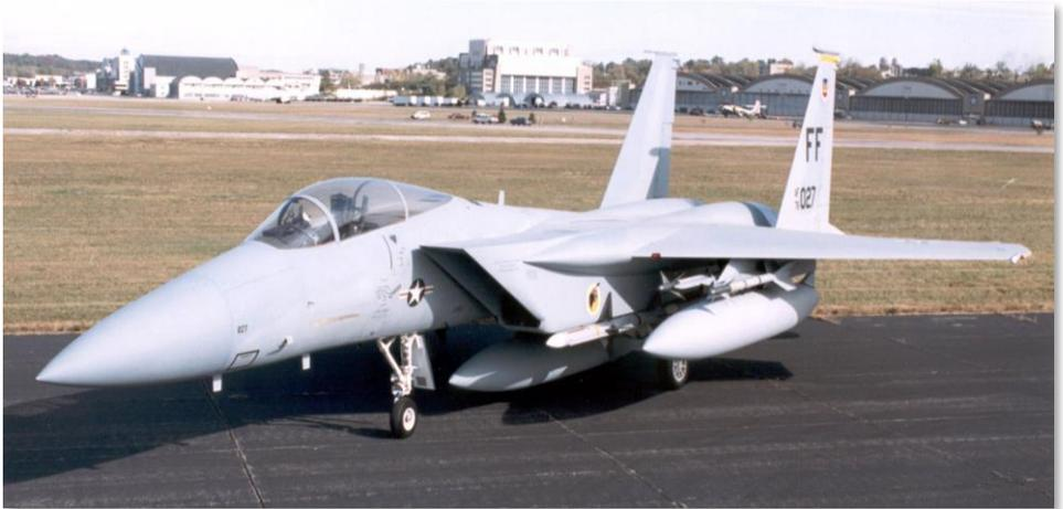
Figure 9 : F-15A avec des missiles AIM-7 et AIM-9
