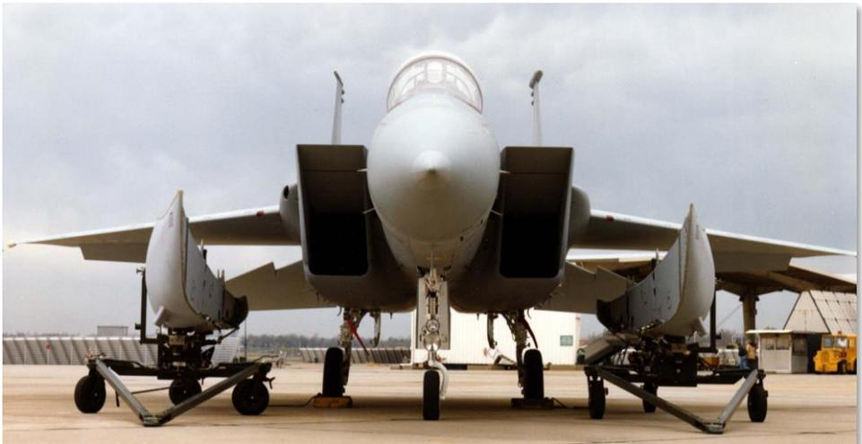
Figure 10 : F-15C avec réservoirs conformes FAST PACK (sur les chariots)
