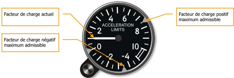
Figure 26. Accéléromètre
