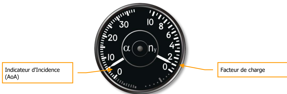
Figure 9 : Indicateur d'Incidence et Accéléromètre
