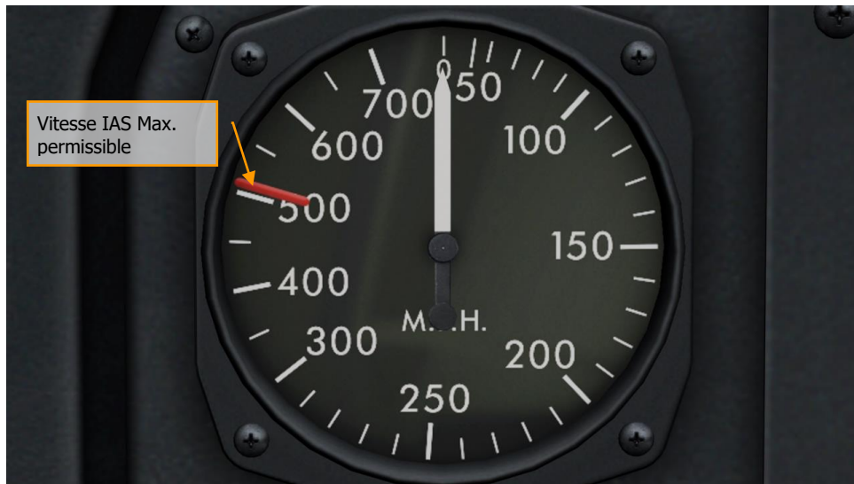
Image 85 : Vitesse IAS Max. permissible 505 mph (808km/h, 440 kts)
