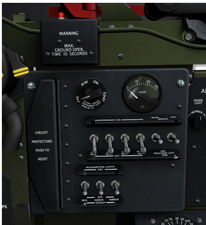
Image 25 : Panneau de Contrôle Électrique
