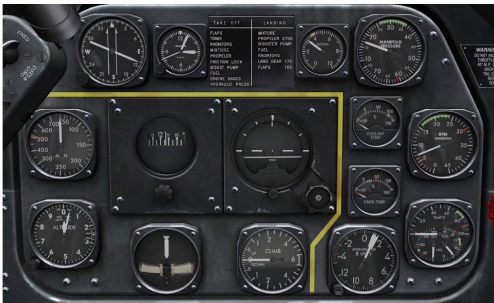
Image 38 : Panneau des instruments du cockpit du P-51D
