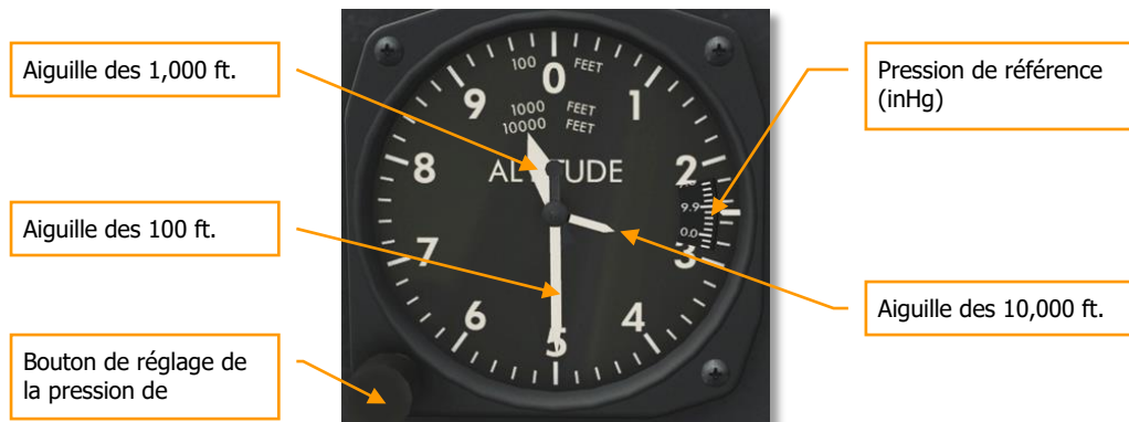
Image 44 : Altimètre AN5760-2 indiquant 29.500 pieds
