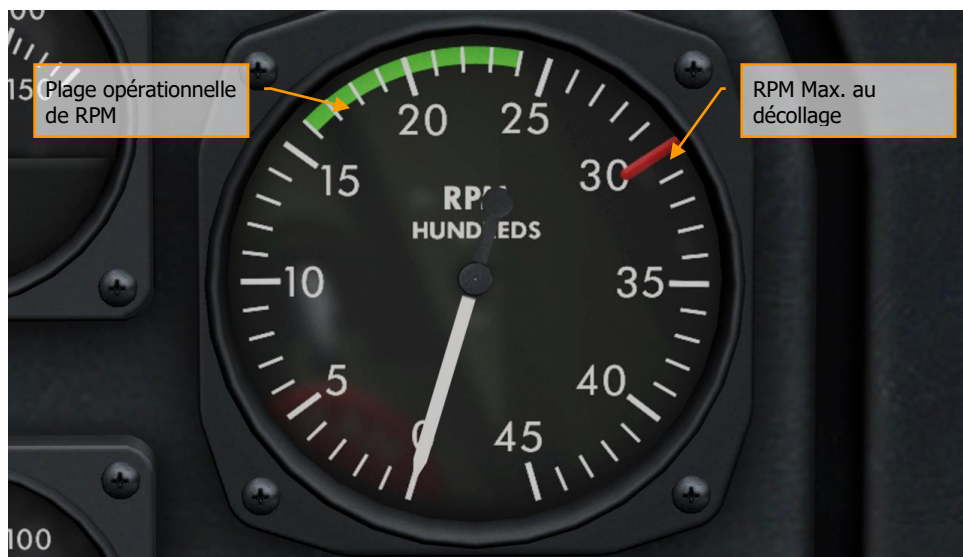
Image 84 : RPM Max. au décollage 3000. Plage opérationnelle 1600...2400.
