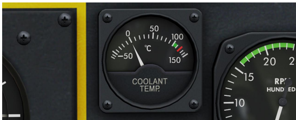
Image 86 : Température Max. du liquide de refroidissement 121°C (250°F), plage opérationnelle 100...110°C (212...230°F)
