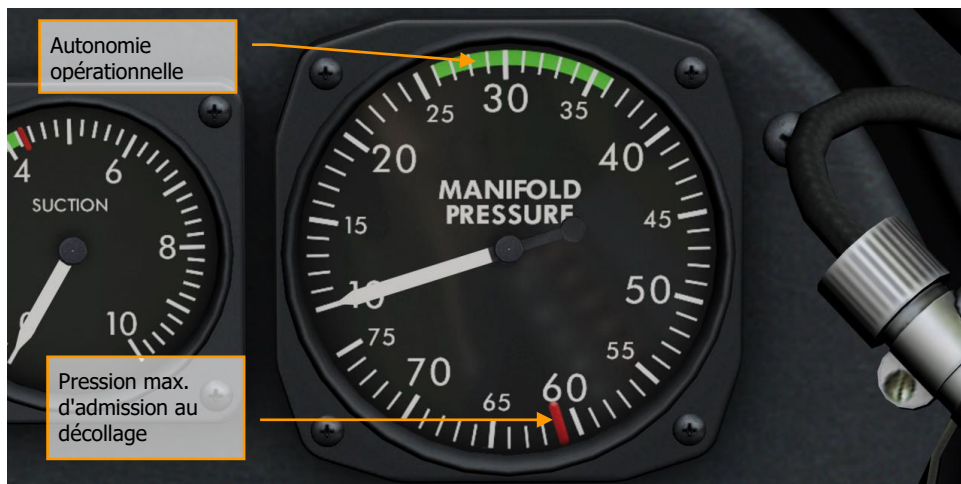
Image 82 : Pression Max. d'admission au décollage - 61 in. HG (155 cm HG) (marque rouge). Autonomie max. 26...36 in. HG (66.04 - 91.44 cm HG) (zone verte).
