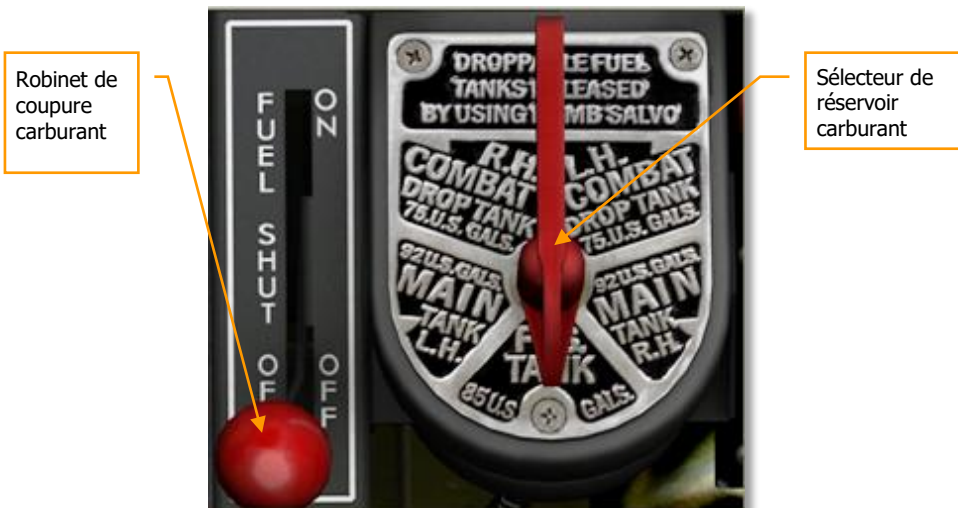
Image 60 : Vanne de coupure carburant et Sélecteur de réservoir carburant.
