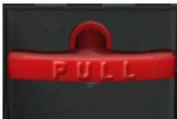
Image 62 : Poignée de largage d'urgence des trappes du train d'atterrissage.
