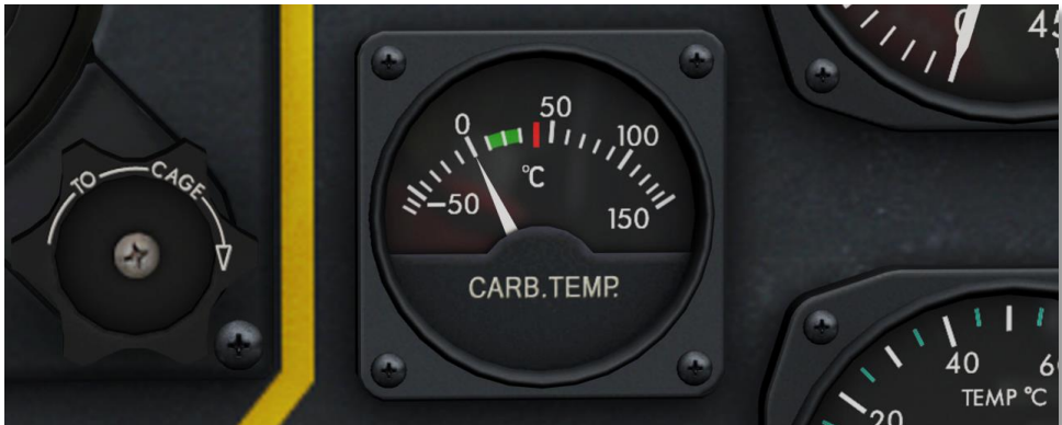
Image 87 : plage de température désirée du carburateur 15...30°C (59...86°F), Maximum 40°C (104°F)
