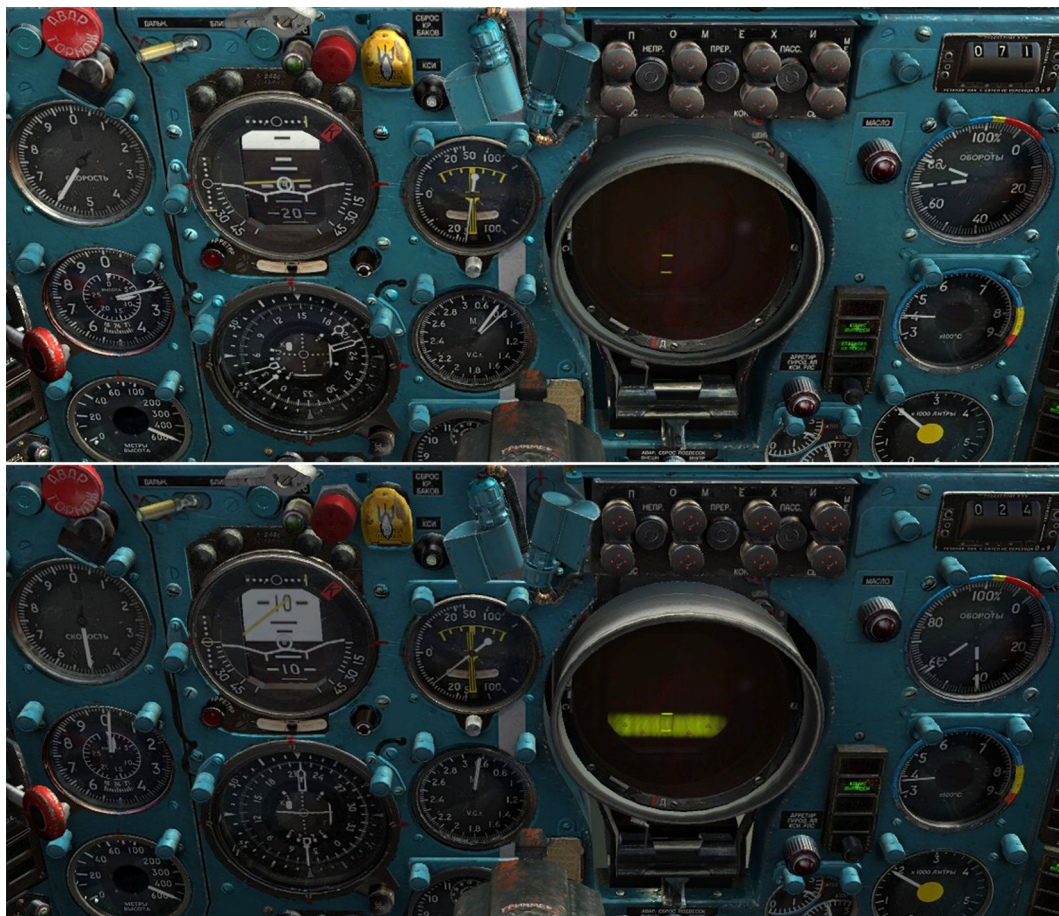
图 9.12：上图显示飞机距离 RBN 基站 71 公里（穿云模式下）。【注意】下降航线处于飞机下方（下滑道指针），而垂直速度在合适范围内（KPP 上黄色的下滑道指针）。下图显示飞机距离 RBN 基站 24 公里，处于下降航线上，但此时下降速度高于推荐值。
