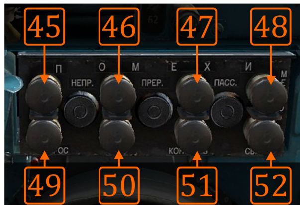
图 10.8：雷达对抗（干扰过滤）和辅助控制面板
