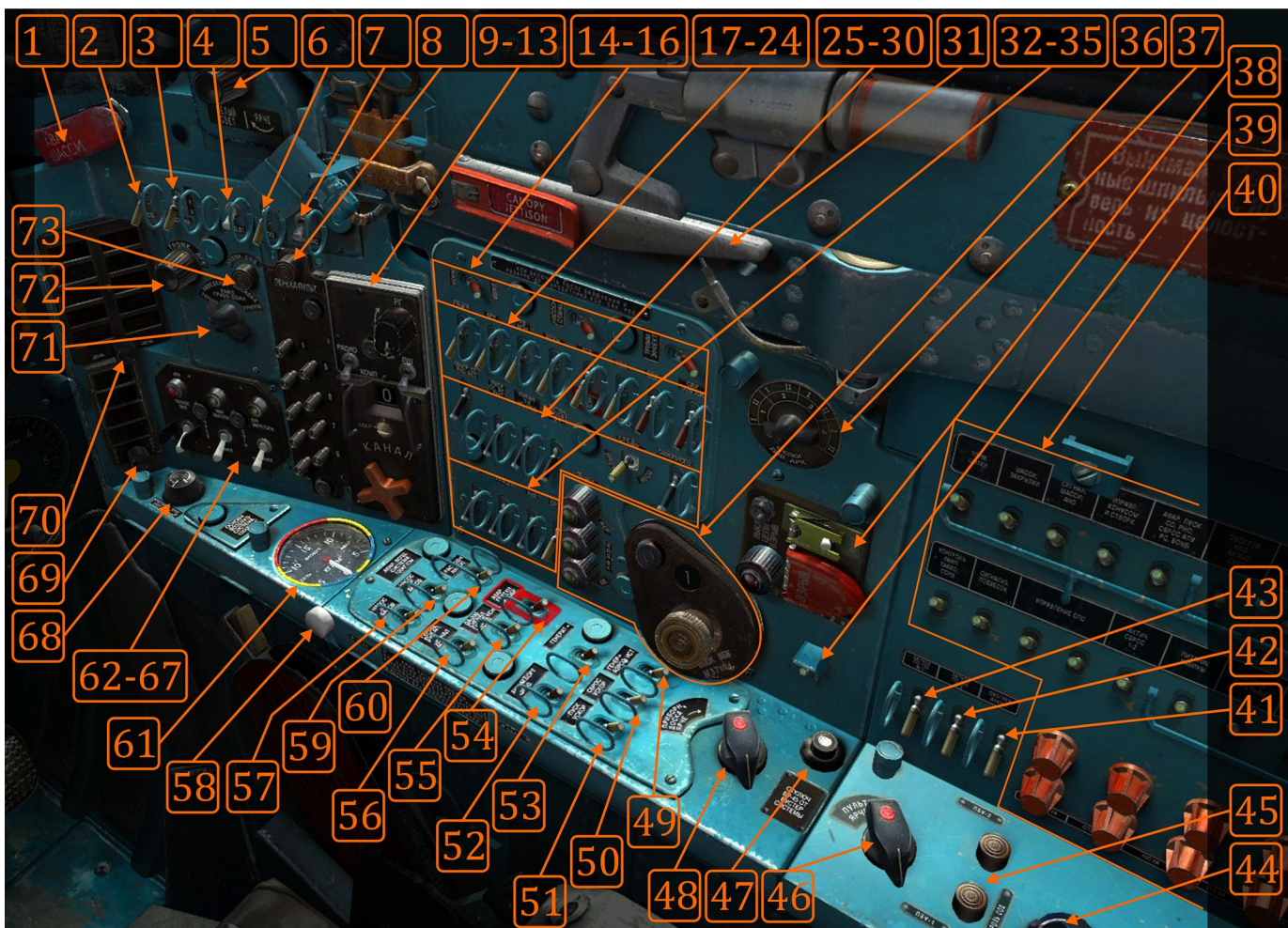
图 6.2 : 座舱右侧区域。开关以从左向右, 自上而下顺序编号。打印用高分辨率图片在目录 Mods\aircrafts\MiG-21BIS\Docs\Manual_Images 下。
