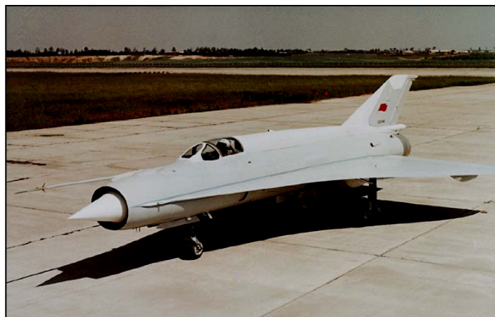
1961 : MiG-21I “Analog” 被用作 Tu-144 客机机翼的研发测试平台
