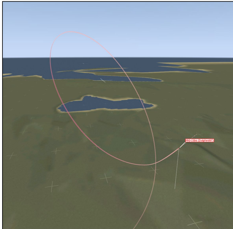
图 8.4： 斜筋斗说明 - 这种情况下，斜筋斗能更好的保持速度，因此飞机具有更高的能量。斜筋斗在空战中很有用处。
