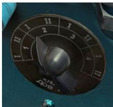
图 9.2： ARC 频率范围或区域选择旋钮（RV37）。一共有 4 个区域（1~4），每个区域包括两个子区域（I 和 II）。因此总共可存储 72 个 ARC 基站信息（4x2x9）。
