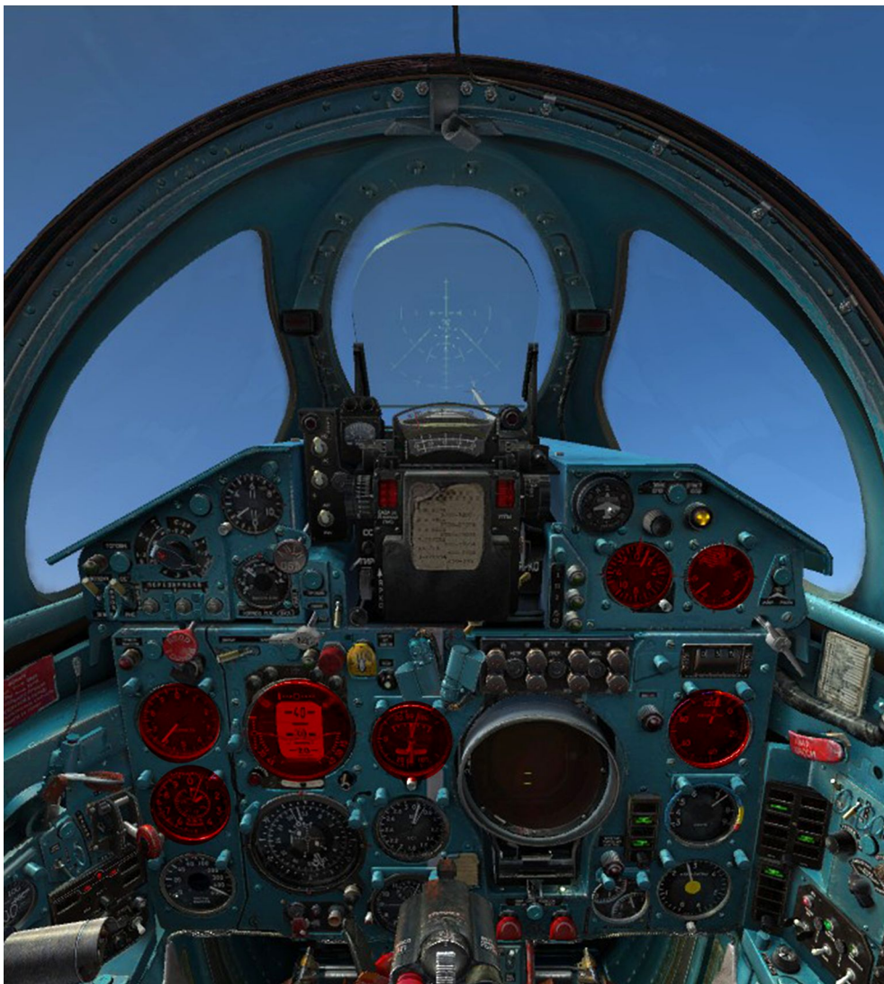
图 8.1： 红色标记的仪表是你必须时刻关注的。此外尽可能多的观察座舱外面的情况。
