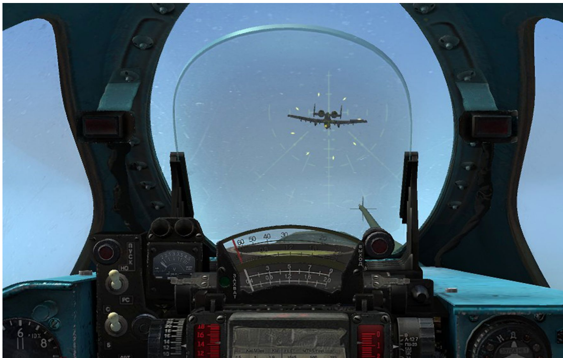
图 10.15：在自动 GYRO（陀螺）模式下（固定距离 300m）使用机炮和光学瞄具来攻击
