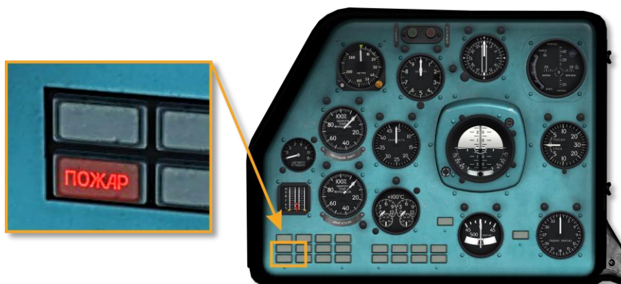
Fig. 7.28. Lamp ПОЖАР (FIRE) on the left dashboard
