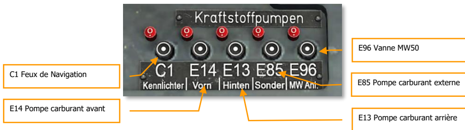
Figure 80 : Disjoncteurs du panneau additionnel
