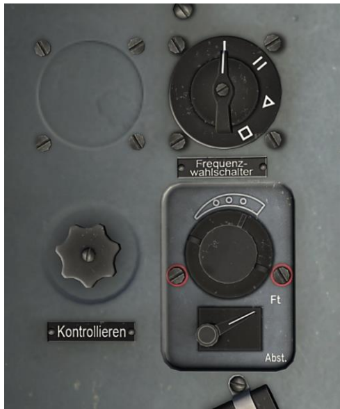
Figure 31 : Sélecteur de fréquence du FuG 16ZY, commande de réglages du récepteur et contrôle du Volume
