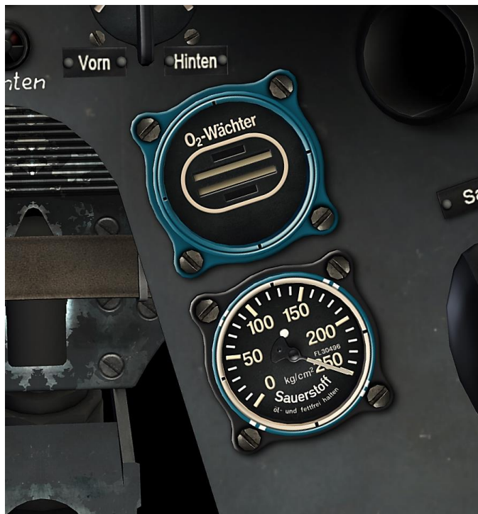
Figure 28 : Indicateur de débit d'oxygène et manomètre
