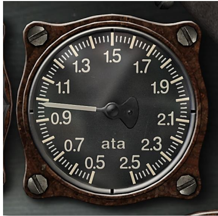
Figure 50 : Jauge de pression du Compresseur
