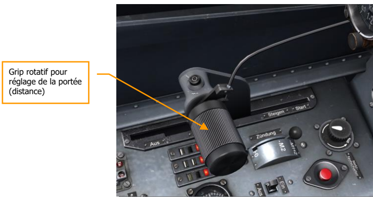
Figure 42 : Manette des gaz avec poignée tournante et câble
