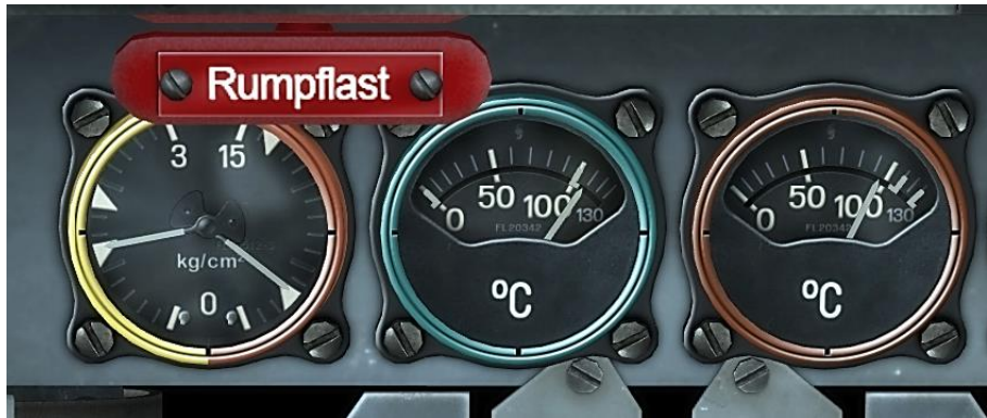
Figure 24 : Jauges de Pression d'Huile et de Carburant, Jauges de température du liquide de refroidissement et d'Huile
