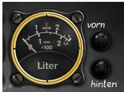
Figure 62 : Jauge de carburant avec témoins lumineux d'alerte
