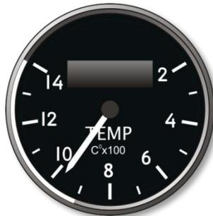
4-13 : Indicateur de température d'entrée de soufflante de turbine (FTIT)
