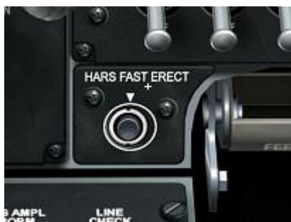
Figure 83. Bouton d'alignement rapide du HARS
