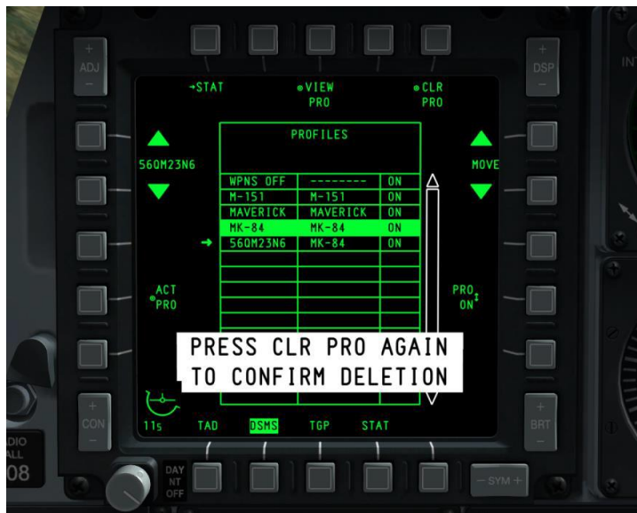
Figure 216. Confirmation de suppression de profil
