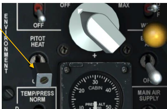
Figure 319. Test du chauffage du tube de Pitot
