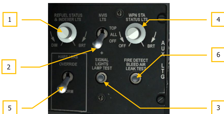
Figure 116. Panneau de commande d'éclairage auxiliaire
