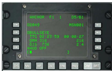
Figure 352. Navigation / Sous-page ancrage
