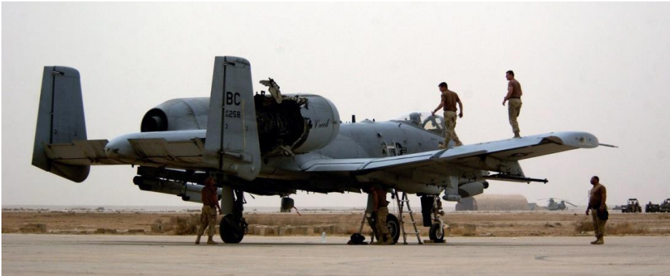
Figure 29. A-10 Thunderbolt II inspecté par l'équipe de maintenance après avoir été touché par un missile Irakien
