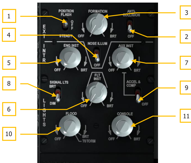
Figure 126. Panneau de commande de l'éclairage
