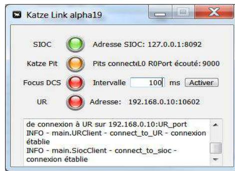
La fenêtre du KaTZ-Link, indique l'adresse de SIOC, et plusieurs voyants (rouge/orange/vert), vous permettent de suivre les connexions au KaTZ-Link. Dans le cas de multiples connexions, vous verrez le nombre de pits connectés, dans cette fenêtre de contrôle.
