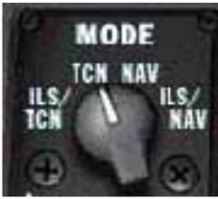
Ce mode est à utiliser lorsque vous cherchez une balise différente de celles de votre plan de vol. C'est dans ce mode que vous pouvez utiliser des waypoints autres que ceux attachés à votre plan de vol. Il vous suffit de rentrer les coordonnées de la base que vous cherchez via l'ICP et le DED, et votre aiguille directionnelle vous indiquera le chemin à suivre, ainsi que la distance (*DME*) vous séparant de la balise sélectionnée.
