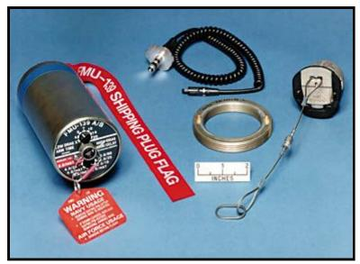
La FMU139 est une fusée électronique pouvant être activée à l'impact ou après un délai suivant l'impact. Cette fusée peut également accepter un signal d'un détecteur de proximité séparé. Le délai avant impact, peut être réglé au sol ou en vol via un appareil équipé de FFCS. Il n'est pas possible de le régler dans le A-10C. Elle est placée dans la queue de la bombe.
