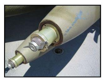
La fusée M904 est une fusée à action mécanique. Elle est armée par la pression de l'air ce qui entraîne une rotation des vanes. Le temps d'armement est indiqué en intervalle de 2 secondes allant de 6 à 18 secondes, réglable au sol avec un simple tournevis. A l'impacte un délai de mise à feu est fournis par l'élément M9. Cette fusée peut être utilisée pour exploser à l'impact ou après un délai suivant l'impact en conjonction avec la fusée de queue M905. Elle est placée sur le nez de la bombe.
